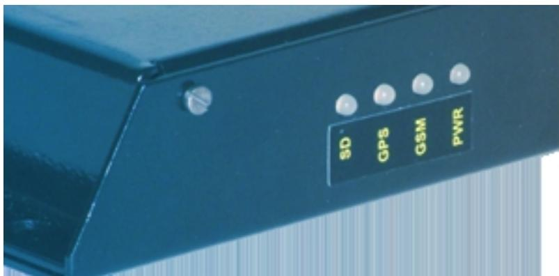
**Встроенный трехосевой акселерометр** обеспечивает стабилизацию координат местоположения контролируемого объекта в сложных условиях приема сигналов спутниковой радионавигационной системы, а также регистрацию фактов перемещения объекта в случае умышленного маскирования GPS-антенн недобросовестным персоналом.
